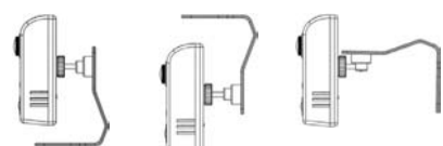
Montage sur table, Montage au plafond, Montage au mur, Montaje en mesa, Montaje en techo, Montaje en pared
